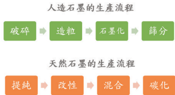
▲ 圖一：人造石墨與天然石墨的生產流程 (source：作者自行繪製)
