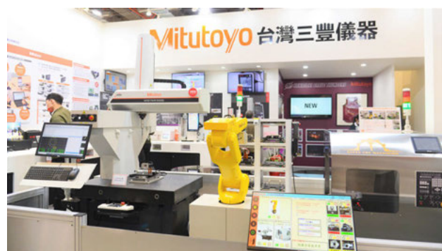
▲ 圖8：台灣三豐展出其加工現場專用三次元測定機，搭配工業機器人、CNC工具機的簡化版自動化量測解決方案，強調可設置於生產線加工設備側的優勢。（攝影：陳念舜）
