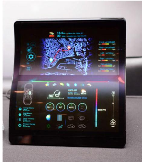
使用Micro LED技術的車用顯示面板。
