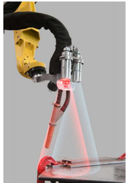
▲ 機器視覺與機器手臂的整合，將有助於產品檢測的效能提升。(Source: Fabricating Metalworking)
