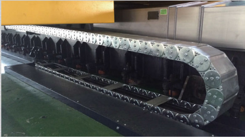
重承載金屬鏈條護管 (使用例)
