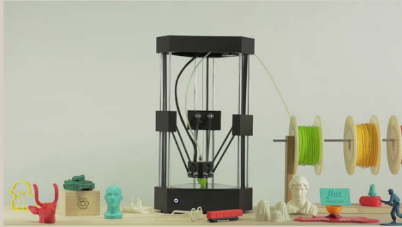
FLUX將噴嘴模組化，可提供3D列印、雷射雕刻和3D掃描三種功能。(Source : Kickstarter)
