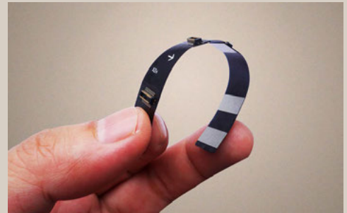
Atomwear的製作過程非常簡單，在FPC（軟性印刷電路板）基板上有六個插槽，用來連接各個不同功能的模組。(Source : Kickstarter)
