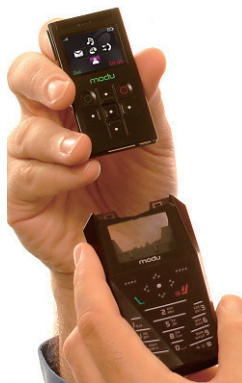
↑ Modu手機只有信用卡般的大小，在接上不同的外殼後，能夠有不同的功能。
