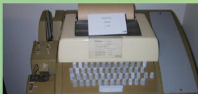
打孔紙之後是電傳機，稱為Electromechanical Teleprinter或Teletypewriter（簡稱：TTY，電傳打字機），輸入用打字，輸出用列印，以此與電腦溝通。
