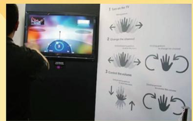
Hitachi展示只要在影像感測器前揮舞手，就可以切換電視頻道、調整電視機音量的技術。
